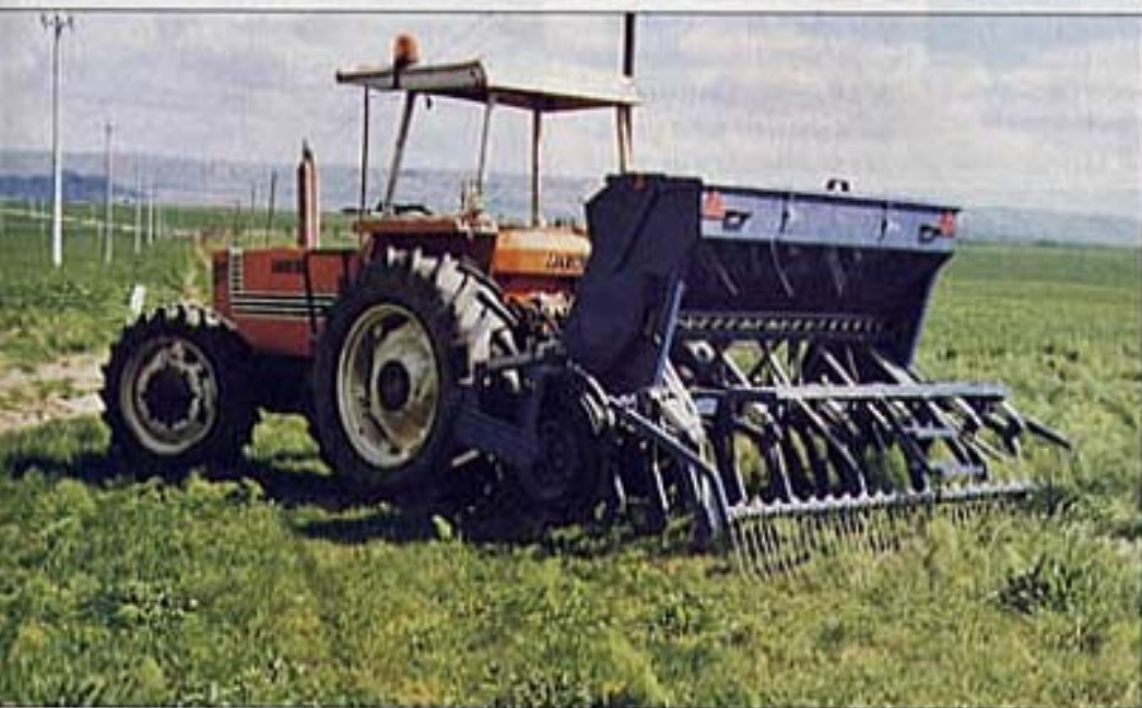
La seminatrice Laseminasodo utilizzata per le prove dimostrative.
